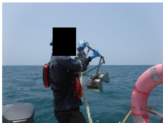
รูปที่ 3-62 การเก็บตัวอย่างสัตว์หน้าดิน (Benthos) ด้วย Petersen Grab Sampler
